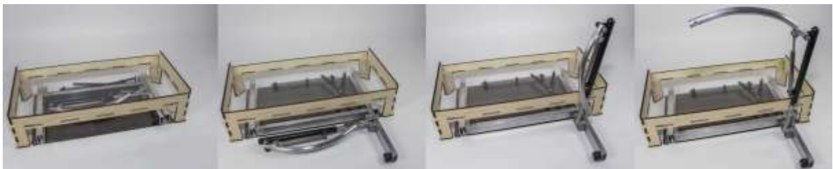
Afbeelding 3: uitschuiven lift en oprichten mast (eigen foto)
